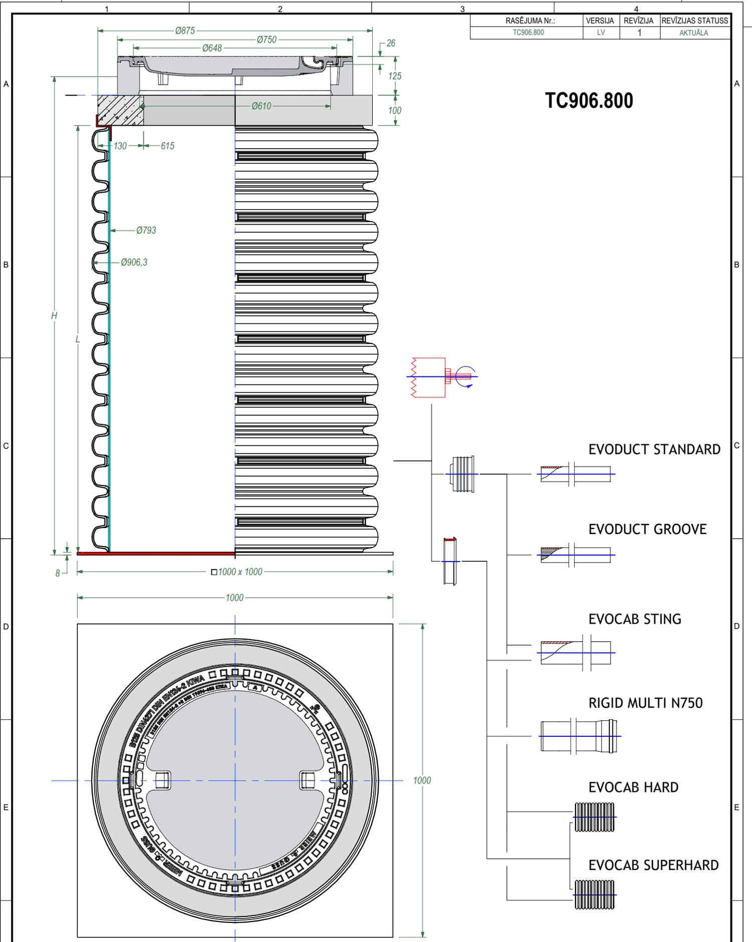
Lūkas pārsedze - LVS EN 124, B125 (125 kN = 12,5 t) vai LVS EN 124, C250 (250 kN = 25 t)
